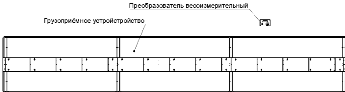
Рис.1 Пример общего вида весов автомобильных ВА (в зависимости от конструктивного исполнения могут отличаться)
